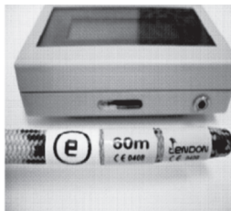
Приложение веревки с чипом к торцу мобильного считывающего устройства
