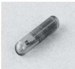
Микроchip – реальный размер приблизительно 15 мм, диаметр 3 мм
